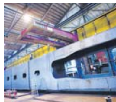
Ein 35 Meter langer Stahlträger, aus dem später der Kranturm entsteht
