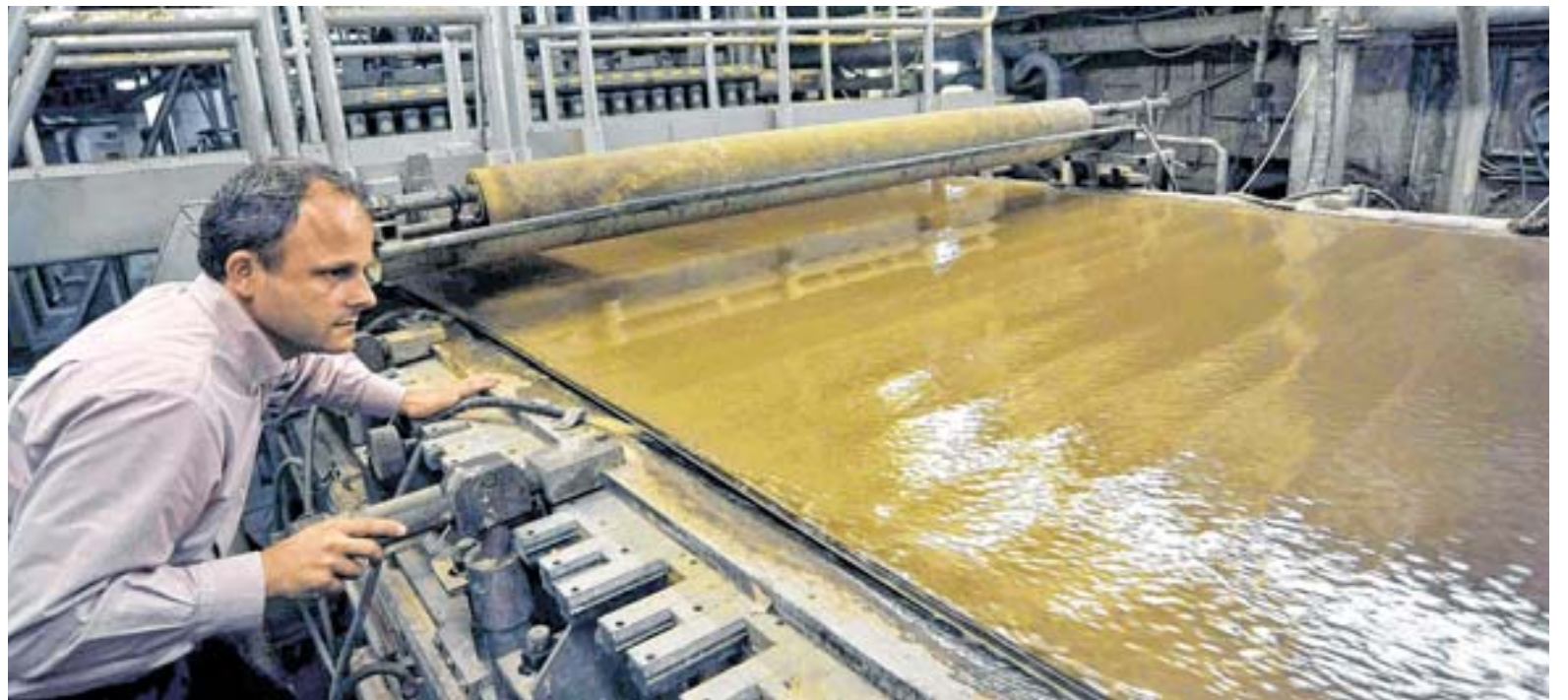
Ingenieur Georg Pingen überwacht die Papierproduktion. An dieser Stelle besteht die fließende Masse noch zu 99 Prozent aus Wasser. Nur ein Prozent sind Papierfasern. Unter dem Sieb wird ein Vakuum erzeugt, das dem Brei Wasser entzieht. Erst, wenn zwei Drittel des Wassers raus sind, verbinden sich die Fasern.
