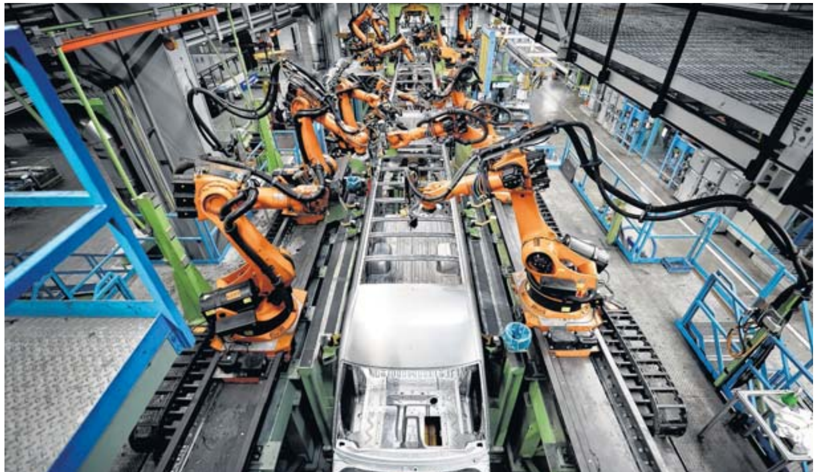
Roboter verschweißen die Teile der Karosserie. Rund 500 sind für den Rohbau im Sprinterwerk im Einsatz.
